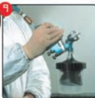
9 Anslut sprutpistolen till luftledningen, vänd appliceringspistolen upp och ner igen och tryck på avtryckaren för att ta bort luft från innerbehållaren.
