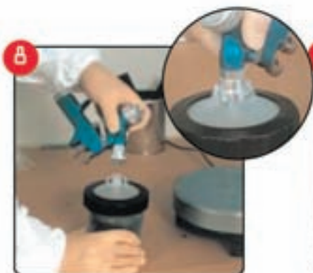
8 Håll sprutpistolen upp och ner och fäst koppen på adaptern.
