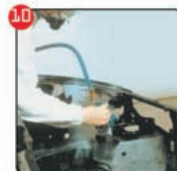
10 Luften behöver endast tas bort om sprutpistolen ska användas upp och ner.
